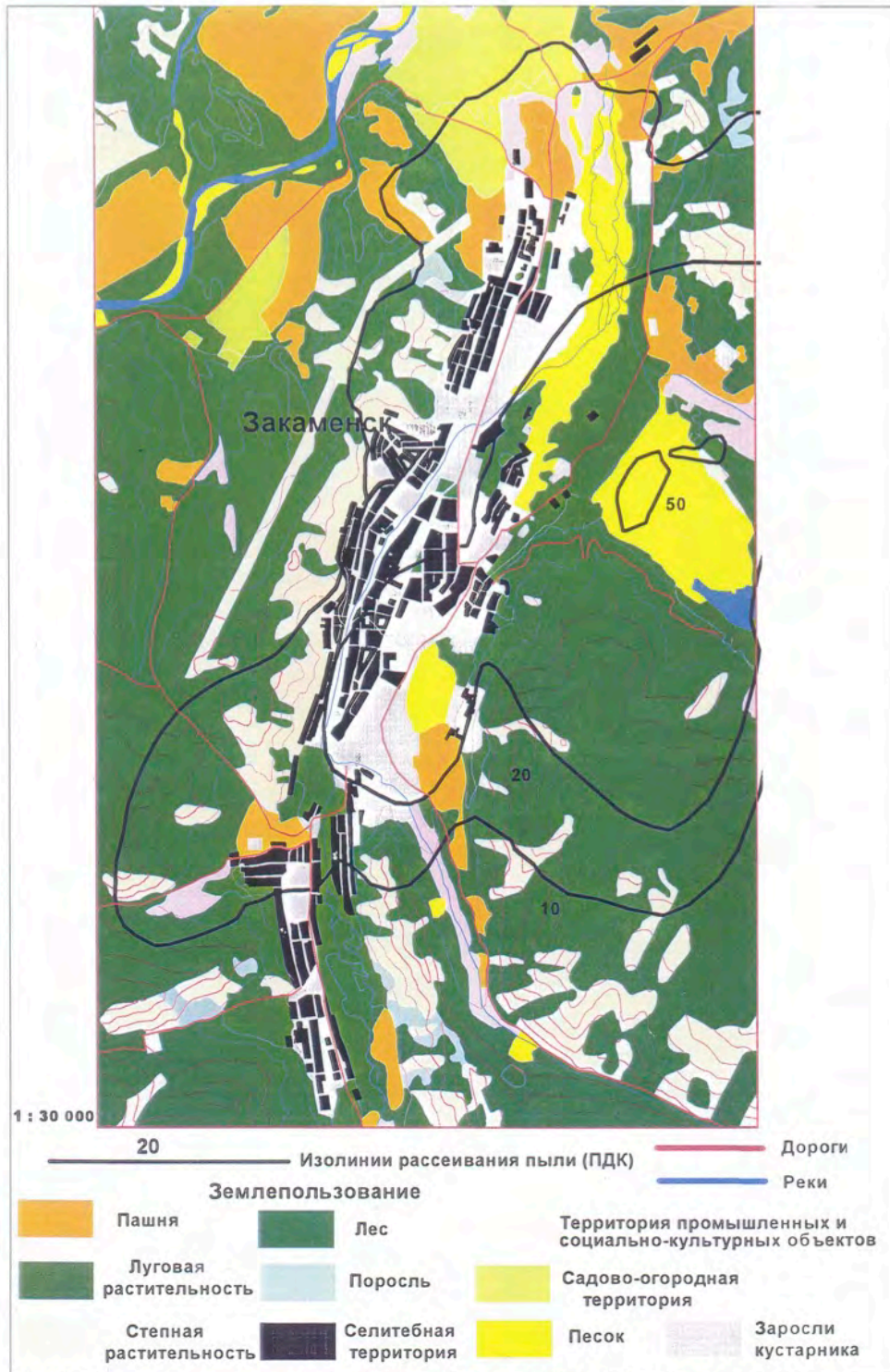
Рис. 5 Поля рассеивания загрязняющих веществ с окрестностей г. Закаменска (Пыль с отвалов Дзидинского вольфрам-молибденового комбината)
